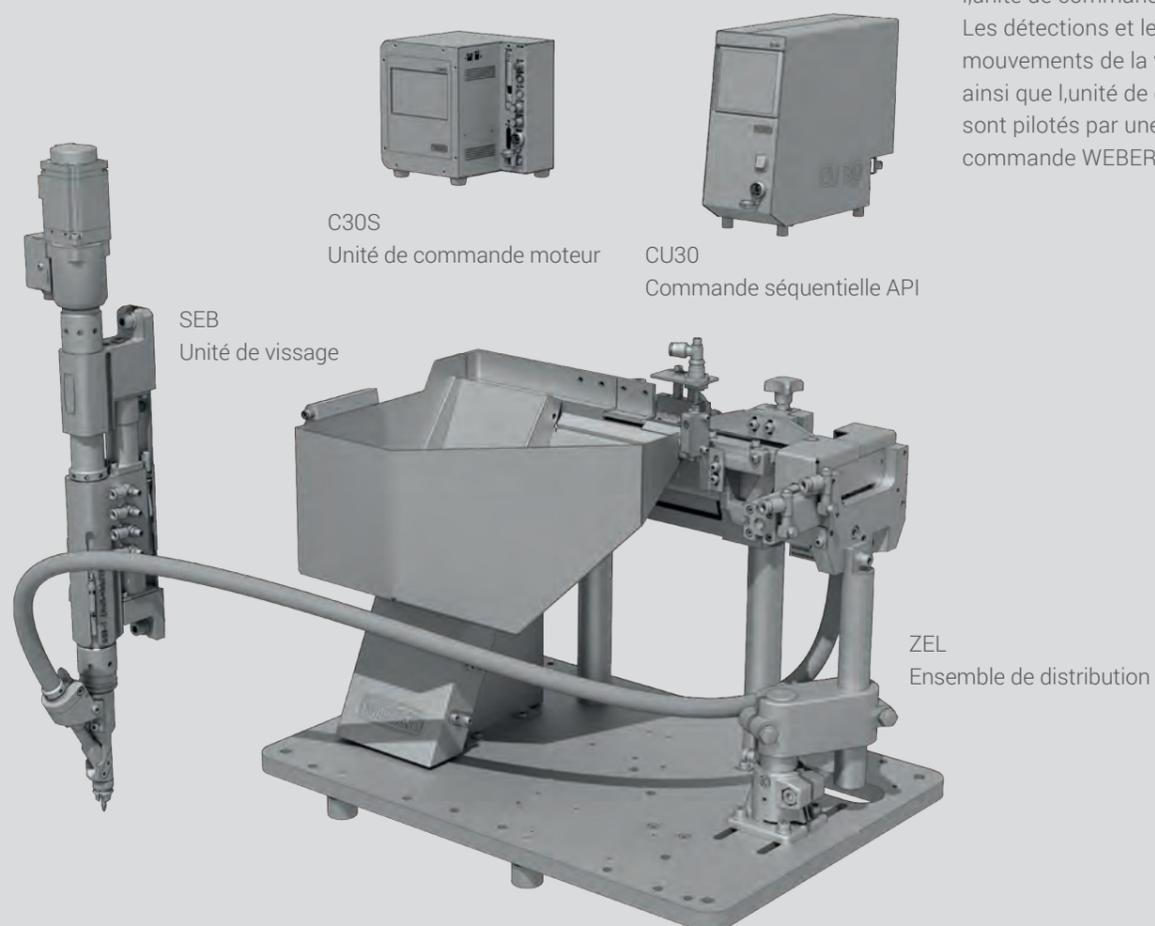
Le concept WEBER c'est le vissage avec distribution automatique de la vis. Les visseuses portatives compactes, comme les visseuses stationnaires obéissent à ce principe. L'automatisation des procédés de vissage a un seul but : réaliser des assemblages rapidement, économiquement et avec fiabilité. Ce principe WEBER est appliqué pour garantir le succès économique de nos clients.
