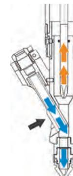
Après avoir terminé son cycle, le tournevis recule, permettant ainsi au bras oscillant de reprendre sa position initiale. En une fraction de seconde, la nouvelle vis est alimentée dans l'embouchure de tête. La visseuse se trouve ainsi prête pour un nouveau cycle.
