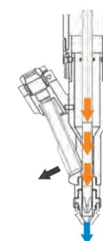
La visseuse se trouve en position, prête à visser, devant la pièce à assembler. Le tournevis avance vers la vis et repousse latéralement le bras oscillant.
