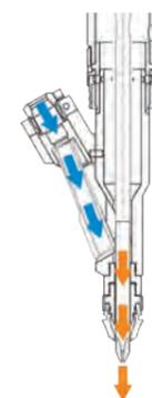
Pendant que le tournevis visse la 1ère vis, la vis suivante est soufflée jusqu'au bras oscillant qui se trouve en position dégagée. Ainsi le temps d'alimentation de la vis est masqué pendant le temps de vissage.
