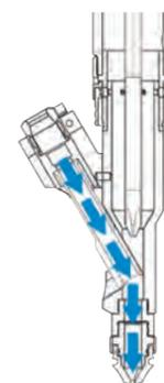
La première vis est soufflée à travers le bras oscillant dans la mâchoire de la tête de vissage. Le conduit d'alimentation ainsi que l'embouchure sont adaptés aux dimensions de la vis afin de garantir un parfait guidage et une alimentation correcte de la vis.
