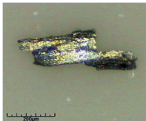
Particelle di metallo del filetto della vite
