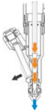
El atornillador se encuentra ya directamente delante del producto en la posición inicial. La punta o herramienta se mueve hacia delante en dirección al tornillo y mueve el brazo oscilante a un lado.
