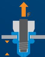
El perno roscado se retrae y la tuerca remachable se deforma
