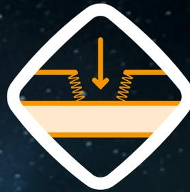
Der schwimmende Kopf führt die Schraube bis sie ins Blech eingedrungen ist, unabhängig von der Vorlochtiefe
