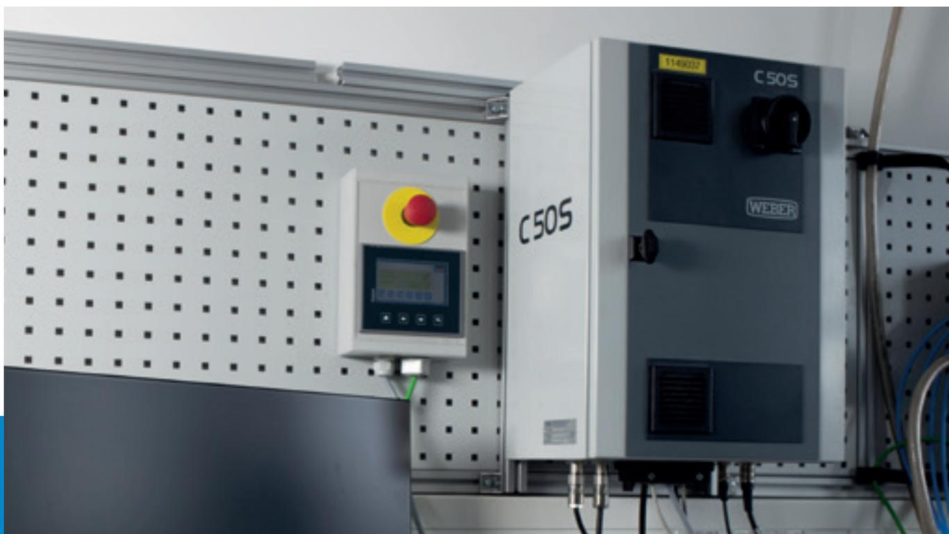
La tecnología de control integrada en los sistemas y las instalaciones de la automatización del atornillado se divide principalmente en controles del proceso de atornillado y controles de secuencia. El controlador del atornillado supervisa y regula el proceso de atornillado real, es decir, garantiza que se respeten los valores predefinidos para la velocidad de rotación, el par de apriete y la profundidad de atornillado. Asimismo, este
