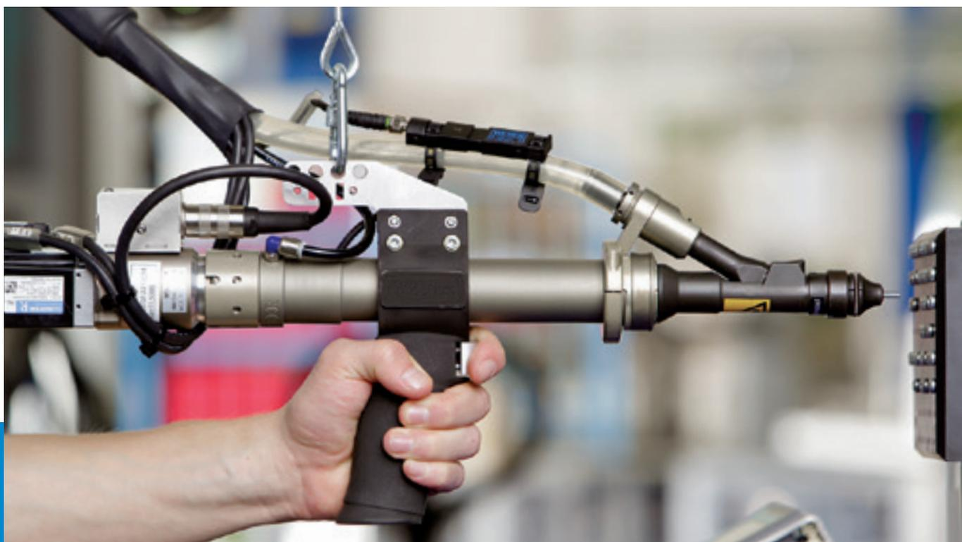
Todos los modelos de atornilladores manuales de WEBER combinan ergonomía y variabilidad. En este sentido, las ventajas de los atornilladores manuales eléctricos y los atornilladores manuales accionados por aire comprimido saltan a la vista: altamente flexibles, eficientes y seguros para el proceso casi al 100 % gracias a la tecnología de control programable. Además, temas como la ergonomía y la variabilidad desempeñan un
