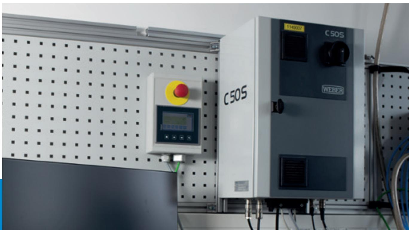
La tecnologia di controllo integrata nei sistemi e negli impianti di avvitatura automatica è suddivisa fondamentalmente in unità di controllo di processo e sequenziatori PLC. L'unità di controllo del processo di avvitatura monitora e regola il processo di avvitatura vero e proprio, fa quindi in modo che vengano rispettati i valori preimpostati per numero di giri, coppia (serraggio a coppia) e profondità di avvitatura.
