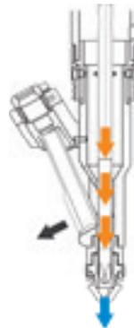
La visseuse se trouve en position, prête à visser, devant la pièce à assembler. Le tournevis avance vers la vis et repousse latéralement le bras oscillant.
