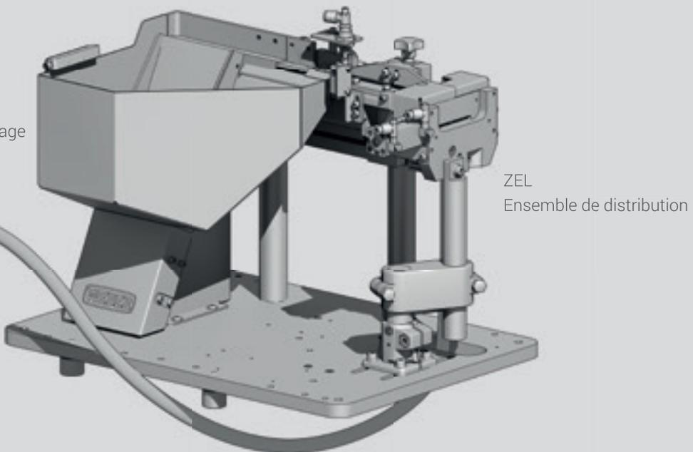
Le „concept WEBER“ c'est le vissage avec distribution automatique de la vis.
