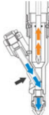
Après avoir terminé son cycle, le tournevis recule, permettant ainsi au bras oscillant de reprendre sa position initiale. En une fraction de seconde, la nouvelle vis est alimentée dans l'embouchure de tête. La visseuse se trouve ainsi prête pour un nouveau cycle.
