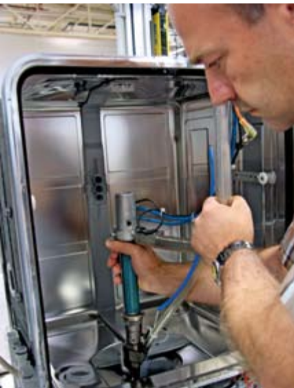
Manfred Deisenhofer (Bild links) konstruierte mit seinem Kollegen Roland Burkart (Bild rechts, Mitte) eine Vorrichtung, die Beschädigungen des Frontpanels und der Innentür während des Schraubprozesses verhindert; Weber Regionalvertriebsleiter Andreas Wieland (rechtes Bild, rechts) erarbeitete die passende Fügetechnik – die Teile werden nun mit dem EC Handschraubsystem HSE mit elektrischem Antrieb verbunden
