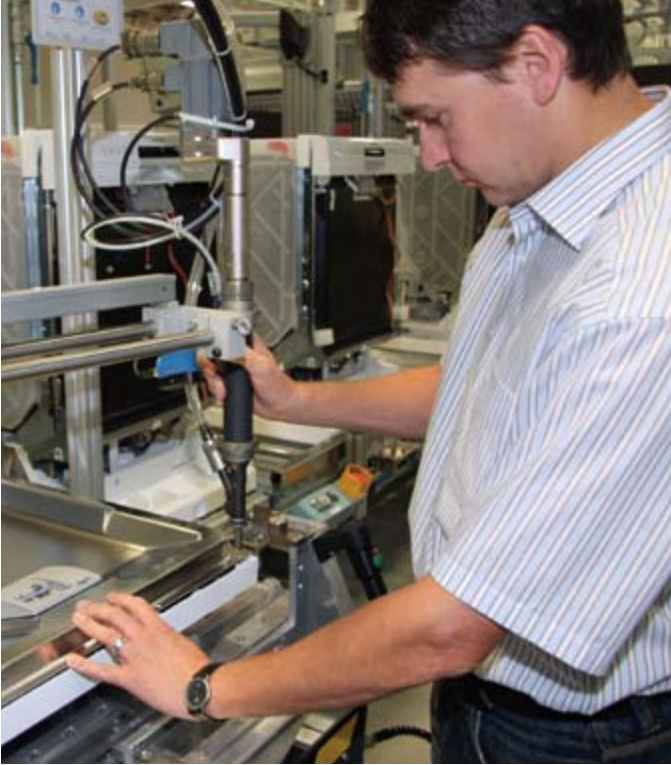
Manfred Deisenhofer (Bild links) konstruierte mit seinem Kollegen Roland Burkart (Bild rechts, Mitte) eine Vorrichtung, die Beschädigungen des Frontpanels und der Innentür während des Schraubprozesses verhindert; Weber Regionalvertriebsleiter Andreas Wieland (rechtes Bild, rechts) erarbeitete die passende Fügetechnik – die Teile werden nun mit dem EC Handschraubsystem HSE mit elektrischem Antrieb verbunden
