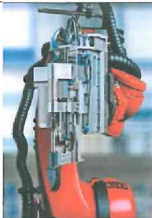
Energiekette macht alle Drehfreiheiten mit.
